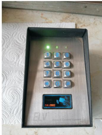
Nach dem Drücken eines beliebigen 5-stelligen Codes wechselt die Led von rot auf grün. Zusätzlich wird beim ersten Tastendruck die Tastaturbeleuchtung eingeschaltet.
