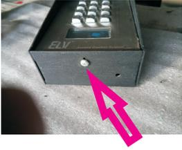
Schraube auf der Unterseite entfernen und Oberteil abnehmen. So kommt man leicht an die Batterien ran und das Unterteil kann an der Wand befestigt werden.
